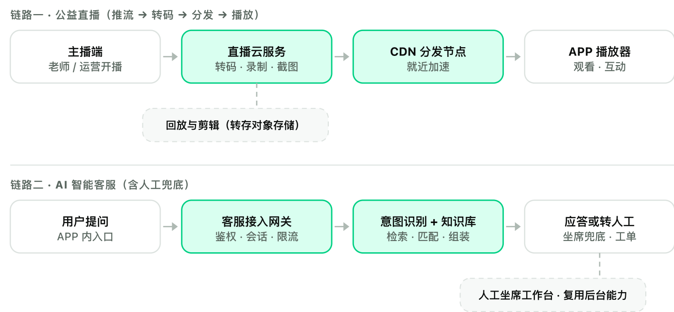
图 5 · 二期直播与 AI 客服链路拓扑 两条外部依赖链路：直播云与 AI 服务，均可替换供应商
